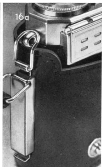
auf das Federstück in die Halteösen (30) der CONTESSA eingehakt (Abb. 16a). Dabei wird die Filmtransportscheibe an der Tasche so gedreht, daß ihre beiden Zapfen in den Aufziehknopf der Camera eingreifen. Eine Öffnung an der Unterseite der Tasche zeigt den Stand der Bildzählruhr (33).
